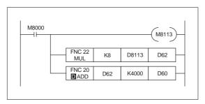
Mit der Applikationsanweisung FNC 22 werden nummerische Daten multipliziert. Im Beispielprogramm wird der Wert aus D8113 mit 8 multipliziert und das Ergebnis wird im Datenregister D62 gespeichert.
