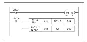
Mit der Applikationsanweisung FNC 22 werden nummerische Daten multipliziert. Im Beispielprogramm wird der Wert aus D8112 mit 10 multipliziert und das Ergebnis im Datenregister D14 gespeichert.
